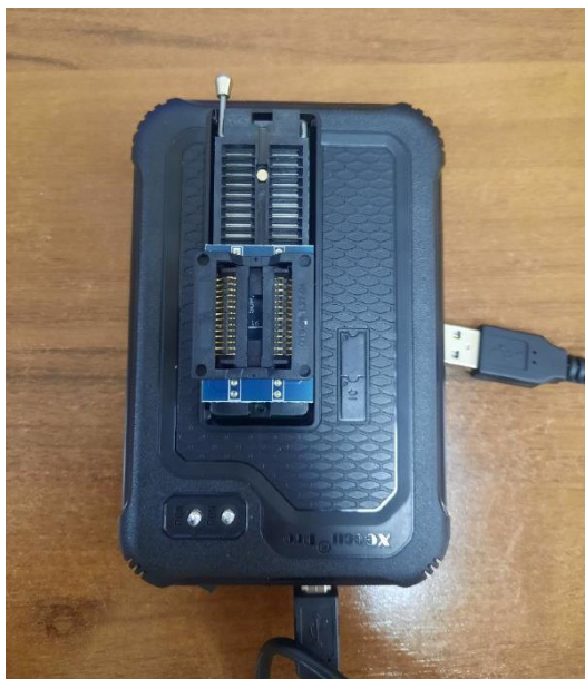
Рисунок 3 – Программатор XГеси T56 с установленным адаптером
